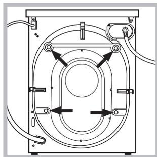
2. Enlever les quatre vis de protection pour le transport, le caoutchouc et la cale, placés dans la partie arrière (voir figure).
