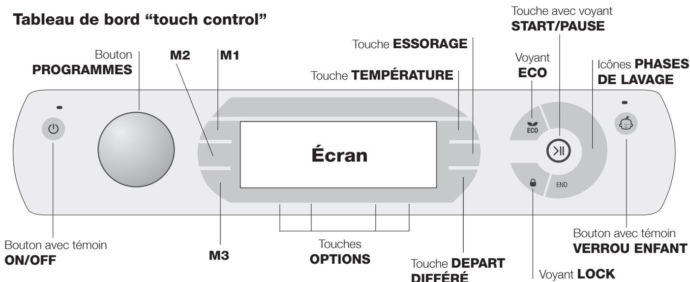
Bouton avec témoin **ON/OFF**: appuyer brièvement sur la touche pour allumer ou éteindre l'appareil. Le témoin vert indique que l'appareil est sous tension. Pour éteindre le lave-linge en cours de lavage, appuyer sur la touche pendant au moins 3 secondes de suite; une pression brève ou accidentelle n'entraîne pas l'arrêt de l'appareil. L'arrêt de l'appareil pendant un lavage annule le lavage en cours.
