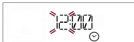
Utilisez  $\wedge$  ou  $\vee$  pour régler l'heure et appuyez sur **OK select** : Les deux chiffres indiquant les minutes clignotent à l'écran.
